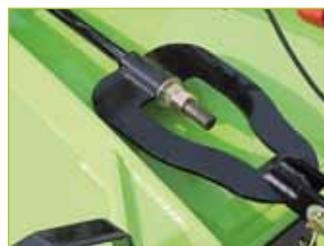
Führungsgestänge zur Einstellung der Deckneigung
