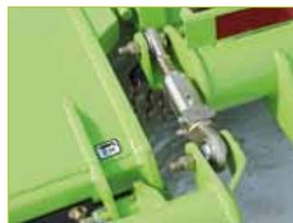
abschmierbare, justierbare Gewinde-Spindeln für Parallel-Höhenverstellung
