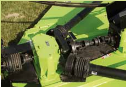
Extrem robuster Antriebsstrang mit Rutschkupplungen
